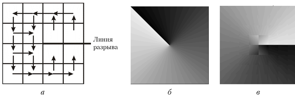
Рис. 11. Алгоритм сшивки поверхности, имеющей разрыв непрерывности. Схема алгоритма (а), поверхность (б) и результат сшивки (в)
