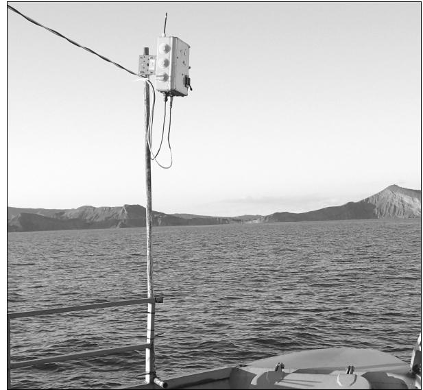
Рис. 1. Полуавтоматический малогабаритный комплекс ЭММА для пассивных дистанционных оптических измерений с борта движущегося судна
