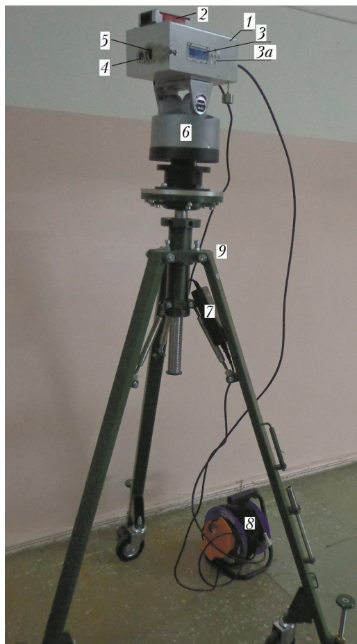
Рис. 3. Выносной блок в сборе: 1 – измерительный блок; 2 – дальномер; 3 – дисплей; 3а – кнопки установки температурного режима в изделии и вывода результатов измерений; 4 – окно видекамеры; 5 – окно фотоприемника; 6 – поворотное устройство; 7 – катушка с кабелем № 1 (витая пара); 8 – блок питания измерительного блока; 9 – штатив
