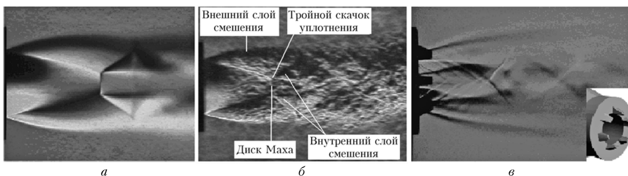
Рис. 1. Шлирен-фотографии струи, полученные теньевым методом при npr = 5 : без шевронов – с большой экспозицией (а), с короткой экспозицией (б); с шевронами с большой экспозицией (в) (внешний вид сопла см. на фрагменте)
