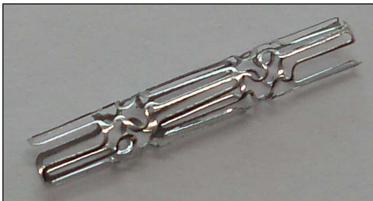
Рис. 6. Возможности прецизионной резки тонколистовых объемных изделий сложной формы на примере изготовленного кардиоваскулярного протеза (стента)
