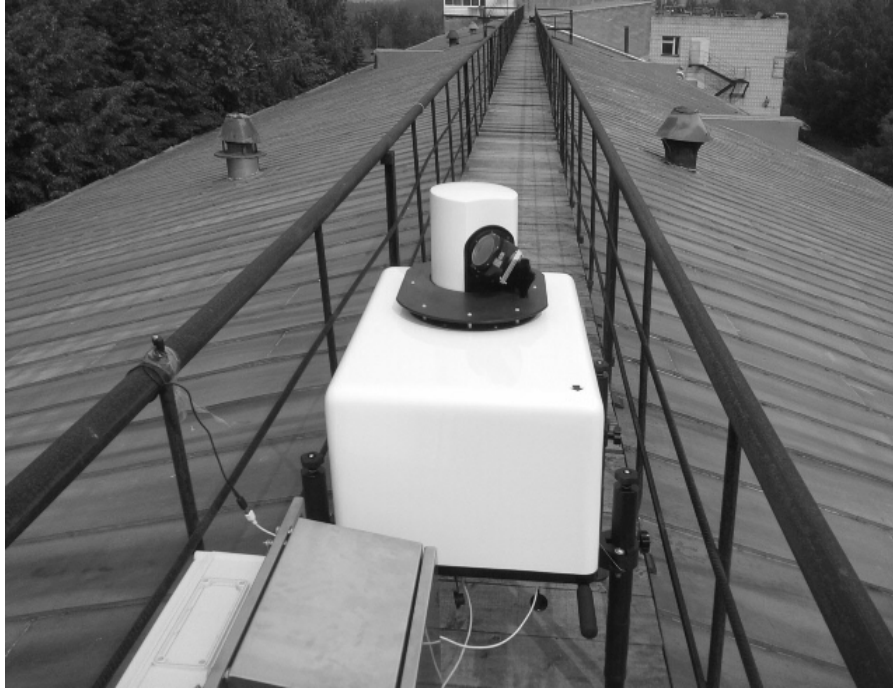
Рис. 1. Когерентный доплеровский лидар «Stream Line» во время проведения экспериментов на крыше здания ИОА СО РАН
