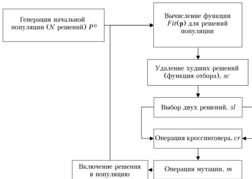
Рис. 1. Блок-структура генетического алгоритма
