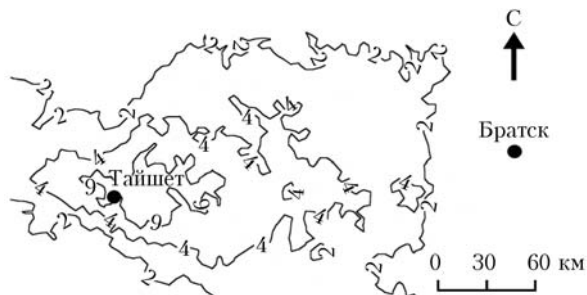
Рис. 3. Изолинии интенсивности осадения сульфатов на подстилающей поверхности региона Тайшет–Братск, \text{кг}/(\text{км}^2 \cdot \text{мес}) , при одном действующем источнике выбросов (Тайшетский алюминиевый завод)
