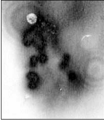
Рис. 1. Распределение плотности энергии отдельного импульса (флюенс) в плоскости поперечного сечения [12]. Длина трассы 75 м, концентрация частиц n \sim 1,7 \cdot 10^4 \text{ м}^{-3}
