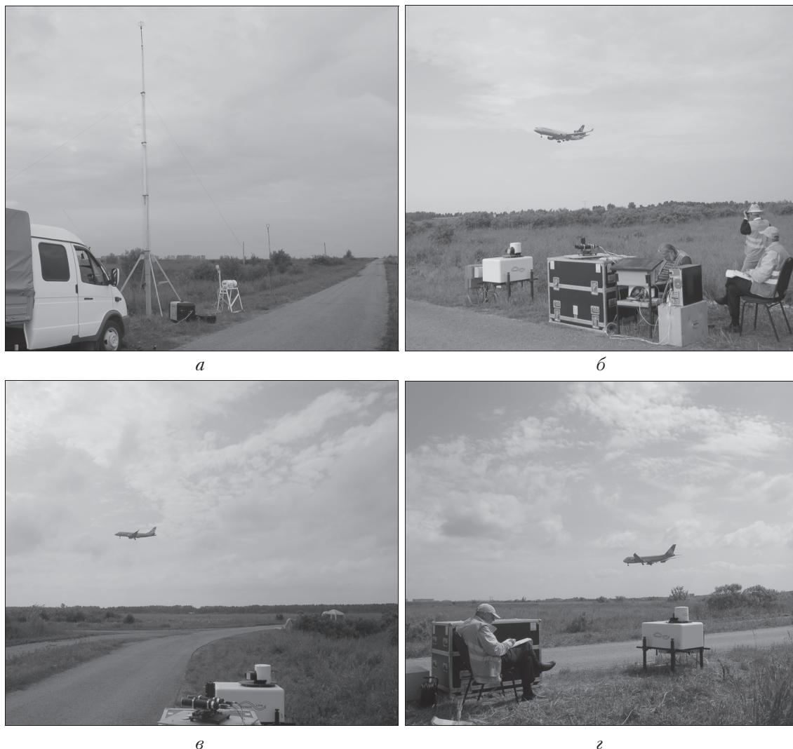
Рис. 2. Эксперимент на летном поле аэропорта Толмачево в 2018 г.: а – 3- и 10-метровые мачты, на которых установлены акустические анемометры АКМ-03, и температурный профиломер МТР-5; б – перед пересечением грузовым самолетом MD-11F плоскости сканирования; в – после пересечения пассажирским самолетом плоскости сканирования; г – после пересечения грузовым самолетом Боинг-747-8F плоскости сканирования
