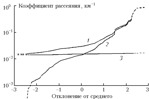
Рис. 1. Интегральное распределение вероятностей для логарифмов коэффициентов рассеяния по данным выборки в 456 измерениях (1 – полное, 2 – аэрозольное, 3 – молекулярное рассеяние)
