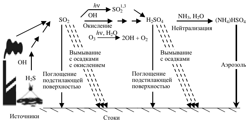
Рис. 1. Схема химического превращения соединений серы в атмосфере
