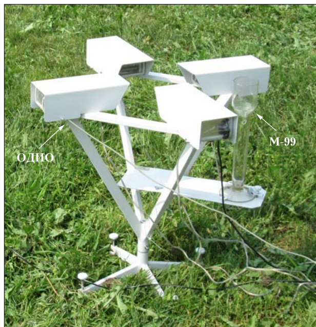
Рис. 6. Расположение приборов при проведении натуральных испытаний ОДИО
