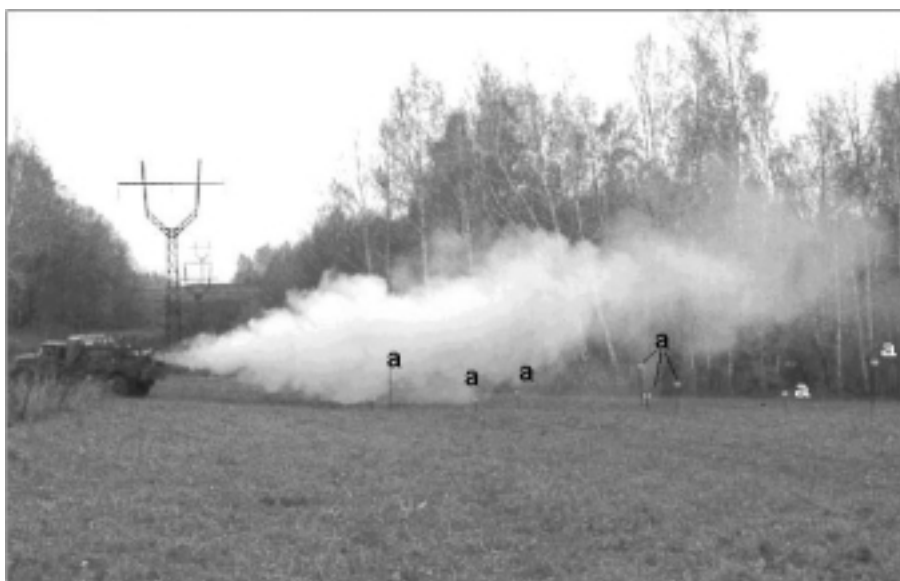
Рис. 1. Пример цифрового снимка с изображением ГРД, дымовой струи и опорных точек
