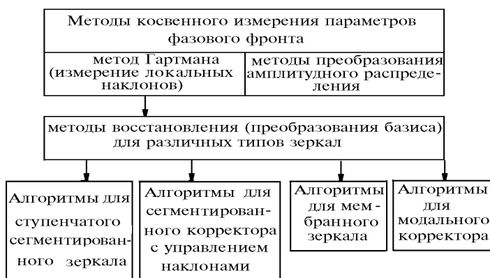
Рис. 1. Классификация алгоритмов фазового сопряжения
