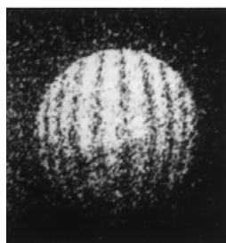
Рис. 3. Голографическая интерферограмма бокового сдвига
