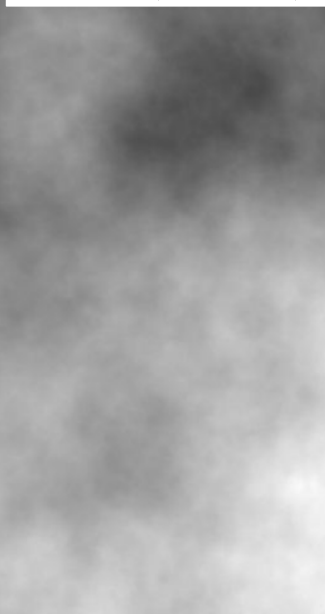
Рис. 1. Пример реализации фазового экрана, описывающего турбулентные флуктуации фазы на участке трассы длиной 10 м в атмосфере. Значения фазы отображаются градициями серого от минимального значения -0,73 (черный) до максимального 1,35 (белый). Размер экрана 75 \times 37,5 см. Внешний масштаб турбулентности L_0 = 1 м, внутренний l_0 = 2 мм
