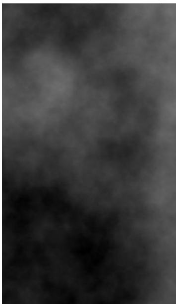
Рис. 1. Пример реализации фазового экрана, описывающего турбулентные флуктуации фазы на участке трассы длиной 10 м в атмосфере. Значения фазы отображаются градициями серого от минимального значения -0,73 (черный) до максимального 1,35 (белый). Размер экрана 75 \times 37,5 см. Внешний масштаб турбулентности L_0 = 1 м, внутренний l_0 = 2 мм
