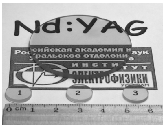
Рис. 6. Вид синтезированных \text{Nd}:\text{YAG} -керамик. Цифры под образцами соответствуют номеру подхода синтеза
