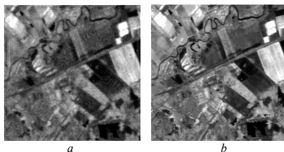
Рис. 7. Фрагмент восстановленного изображения инверсией ФРТ ( a ) и соответствующий фрагмент исходного изображения ( b )
