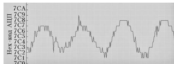
Рис. 5. Результат оцифровки синусоидального напряжения малой амплитуды
